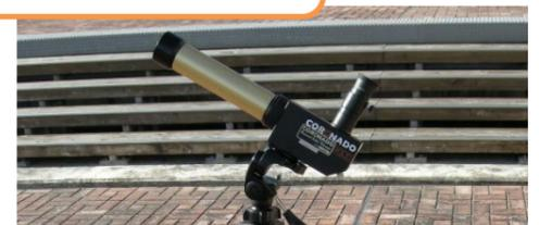
「太陽望遠鏡」。水素が出すH $\alpha$ 線(光)のみ透過させるので、太陽を直接見ることができます。
